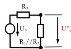
$$U''_S = \frac{U_2}{R_2 + \frac{R_1 R_3}{R_1 + R_3}} \frac{R_1 R_3}{R_1 + R_3} = \frac{U_2}{R_1 R_2 + R_1 R_3 + R_2 R_3} R_1 R_3$$
