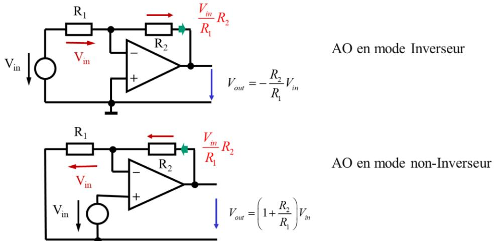
Une fois la réaction négative réalisée, la tension de sortie de l'amplificateur opérationnel prendra des valeurs différentes selon que le signal d'entrée est ‘dirigé’ vers l'entrée + ou l'entrée - .
