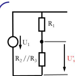
$$U'_S = \frac{U_1}{R_1 + \frac{R_2 R_3}{R_2 + R_3}} \frac{R_2 R_3}{R_2 + R_3} = \frac{U_1}{R_1 R_2 + R_1 R_3 + R_2 R_3} R_2 R_3$$
