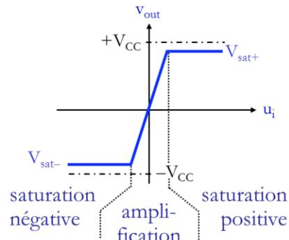
L'amplificateur opérationnel est un composant de base très important, utilisé dans de nombreux montages électroniques analogiques.
