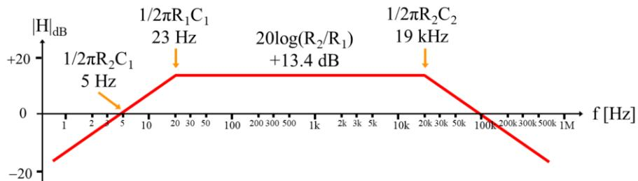
Il s'agit d'un circuit qui atténue en dessous de 5 Hz et au dessus de 100kHz, avec un gain constant de 4.7 (13.4 dB) entre 20Hz et 19 kHz, ce qui correspondrait à la gamme audio.
