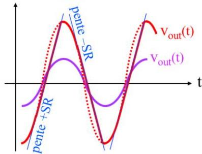
A cause de leur structure interne, les amplificateurs opérationnels ont aussi une limitation de la vitesse de variation de la tension de sortie appelé Slew Rate. Les fabricants spécifient ce Slew Rate :  $SR = (dv_{out}/dt)_{max}$  en V/ $\mu$ s.
