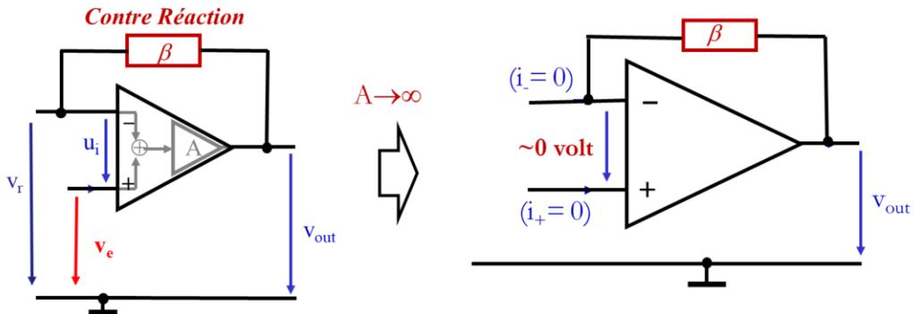
Cette remarque sera très utile : on peut résoudre les circuits en supposant qu'il y a 0 volt entre  $V_+$  et  $V_-$
